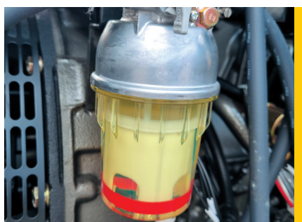
8. Фильтр-водоотделитель топлива с прозрачной колбой
